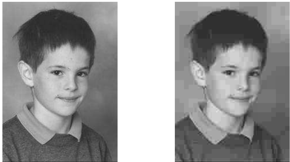
Abbildung 4: JPEG-Kompression eines 200 \times 279 True-Color-Bildes, unkomprimierter Speicherbedarf: 163 KB. links: Dateigröße: 7,3 KB, Kompression 22:1. rechts: Dateigröße 2,5 KB, Kompression 65:1
